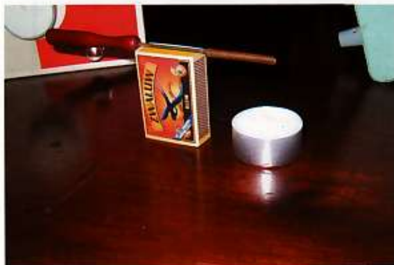
Het door een waxinelichtje verwarmde soldeerboutje van het Step by Step-bouwpakket
